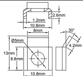
Ponticello per viti M4 con protezione antitaglio, foro da 5 mm, da montare sui terminali delle morsettiere ceramiche serie BCA, BCB; incompatibile con la serie BCC.
