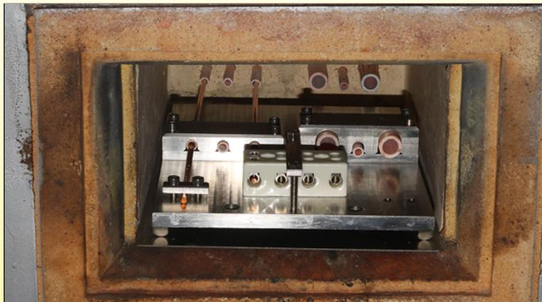
Forno di test per la resistività della ceramica in funzione della temperatura (Laboratorio Ultimheat)
