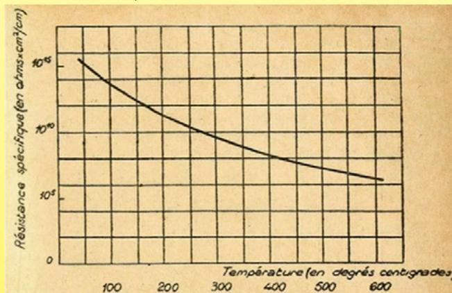
Variation de la résistance spécifique en ohm.cm/cm<sup>2</sup> de la porcellane en fonction de la température (courbe logarithmique). Tra 20°C et 300°C la sua resistenza è divisa per 10,000 (1945 Matériaux électrotechniques modernes, Ultimheat Museum).
