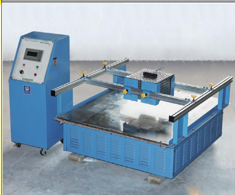
Attrezzatura per i test di vibrazione
