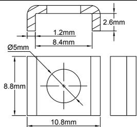
Sella per viti M4, foro da 5 mm, da montare sulle morsettiere in ceramica delle serie BCA, BCB e BCC.
